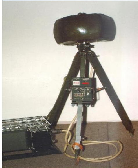
Radar SONA do pomiaru prędkości wylotowej pocisków
