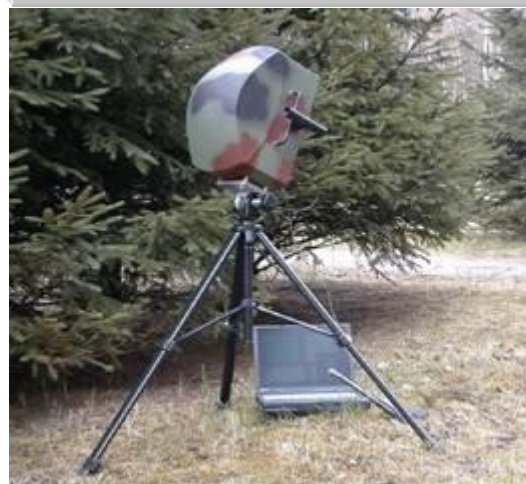
Radar do pomiaru prędkości początkowej pocisków RUBIN
