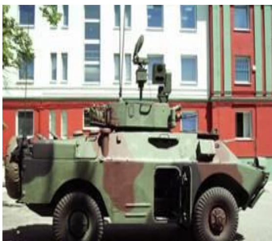
Pojazd opancerzony pokryty absorberem mikrofalowym typu powłoka malarska
