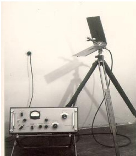
Nadajnik zakłóceń radiolokacyjnych KABUL na pasmo 20 cm
