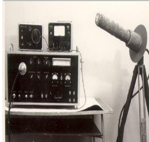
Nadajnik zakłóceń radiolokacyjnych DAKAR na pasmo 50 cm
